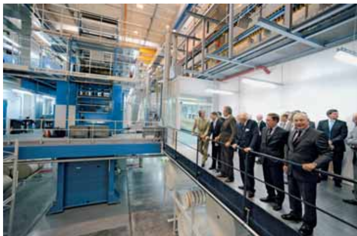
Richard Zöller (devant à dr.) se réjouit de l'intérêt suscité par sa nouvelle KBA Cortina 6/2. Directeur technique du pôle presse de MDS depuis des années, ce n'est pas la première fois qu'il met en service une nouvelle rotative KBA avec son équipe, mais c'est la première en offset sans mouillage
