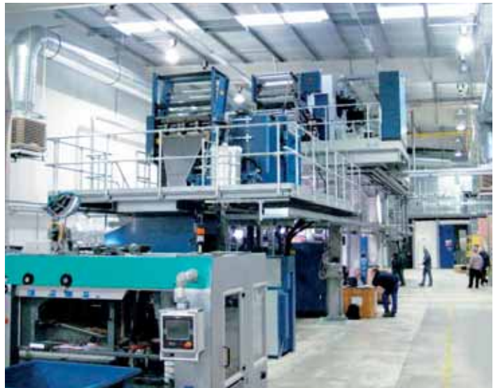
Plus grande qu'une presse feuilles : la ligne KBA Continent lors du montage final
