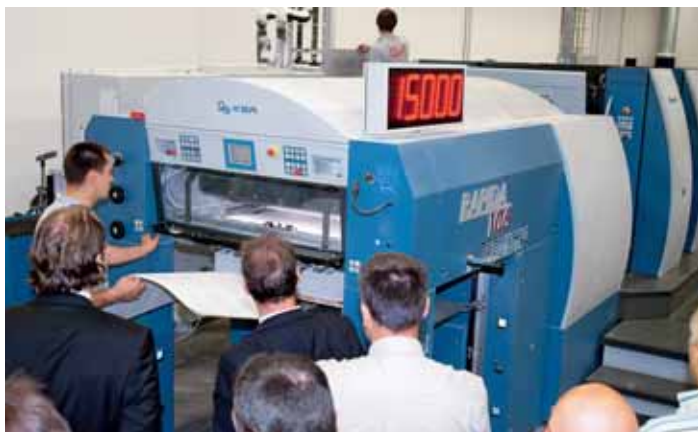
... la machine reprend ensuite sa pleine vitesse de production, soit 15 000 feuilles/h en retraiton
