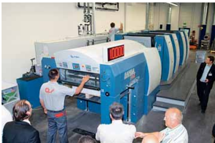
Première mondiale : durant l'impression à 10 000 f/h sur les groupes 1 et 3, le changement des plaques est effectué automatiquement sur les groupes 2 et 4...
