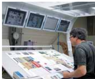
À peine 15 minutes sont nécessaires pour la mise en train d'un magazine professionnel jusqu'à la sortie d'exemplaires vendables, même avec un changement complet
