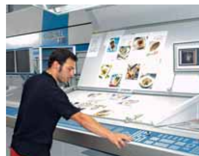
Les pupitres KBA ErgoTronic sont dotés de systèmes EasyTronic et LogoTronic pour un démarrage rapide et une faible gâche
