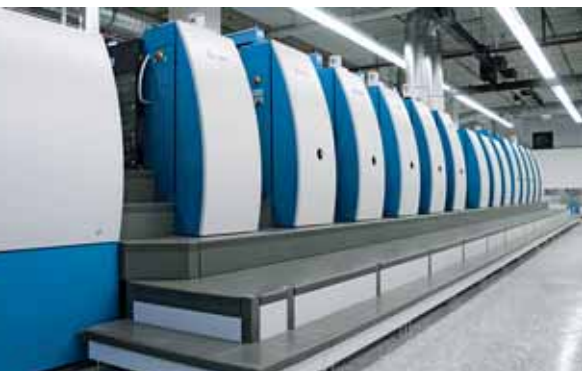
Avec un margeur bobine-feuilles et cinq groupes d'impression, groupe vernis et deux sécheurs avant le retournement à conversion automatique, cinq autres groupes d'impression et tour de vernissage avec sécheur en fin de ligne, la KBA Rapida 105 d'Irwin Hodson Press mesure 35 m de long
