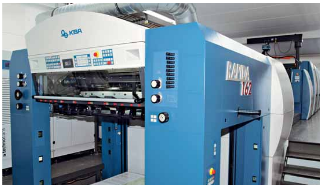
La millième Rapida grand format est une cinq-couleurs en format 162a avec tour de vernissage et sortie rallongée. Une machine semblable est déjà en production depuis 2005 chez Berlin-Mitte
