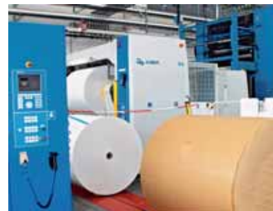
L'alimentation en papier du dérouleur Pastomat RC est assurée par le système automatique Patras A
