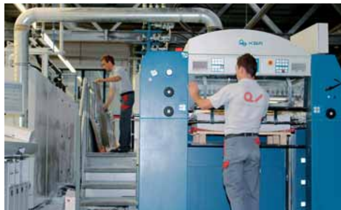
Pendant que Johannes Guggenmos (devant) surveille la production sur la Rapida 106 huit couleurs, Bruno Campos-Feil met en place les nouvelles plaques dans les groupes
