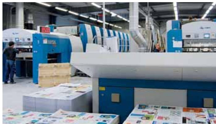
Les deux Rapida grand format sont dotées de toutes les options, dont le système QualiTronic professional de mesure et de régulation en ligne de l'encre
