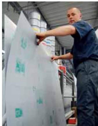
Le changement des plaques et de format s'effectue en 4 minutes, lavage compris
