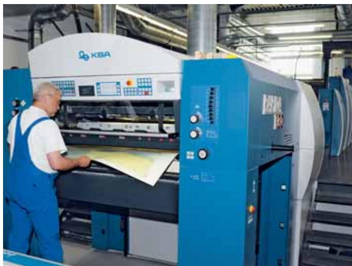
La Rapida 130 quatre couleurs avec tour de vernissage et sortie rallongée est la plus récente et aussi la plus grande des machines de l'atelier moderne du BSH
