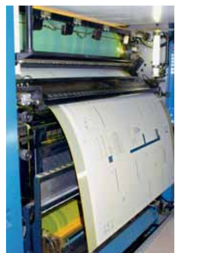
Le changement semi-automatique des plaques contribue largement à accélérer la mise en train
