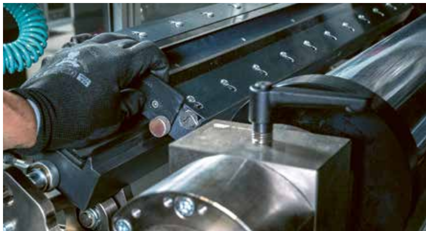
Schneller und sauberer Rakelwechsel mit fortgeschrittenem Klemmsystem
