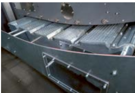
Tunnel di asciugamento finale a due livelli con ingombri ridotti e massima efficienza di asciugamento
