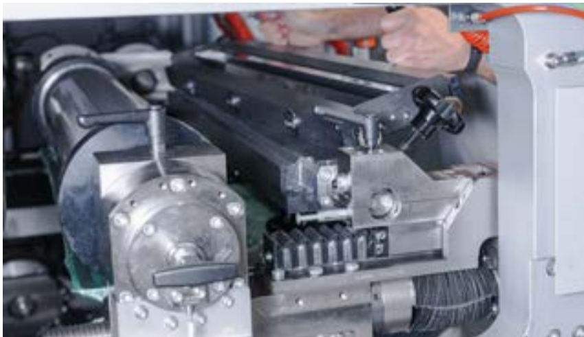
Sistema di estrazione rapido camera racla
