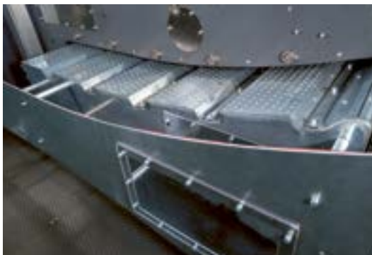
Túnel de secado de dos niveles con un tamaño reducido y una capacidad de secado excepcional
