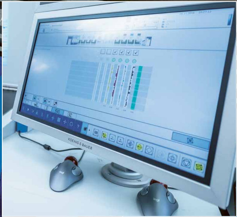
Das QualiTronic ColorControl befindet sich hinter dem letzten Druckwerk. Bei Wendemaschinen ist ein zweites System hinter dem letzten Druckwerk vor der Wendung installiert. Die Bedienung und Anzeige erfolgt über den Leitstands-Monitor
