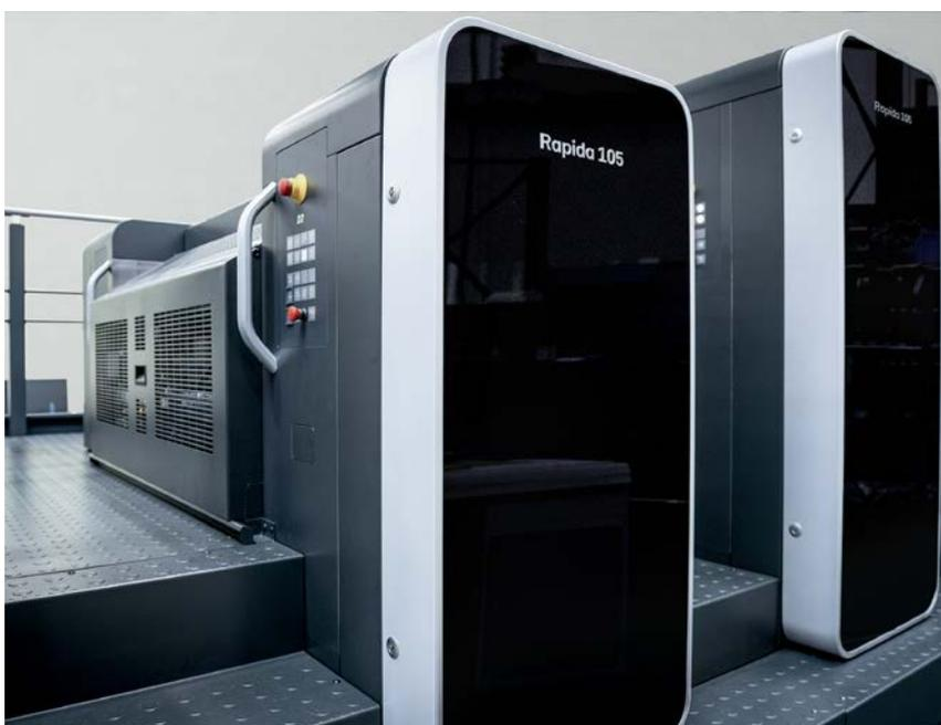
Genauso groß wie die Bedruckstoff-Vielfalt zeigt sich das Anwendungsspektrum der Maschine: Für den **Akzidenzdruck** stehen Maschinenvarianten mit bis zu acht Farbwerken und Bogenwendung für den 4 über 4-Druck im Inline-Prozess zur Verfügung.
