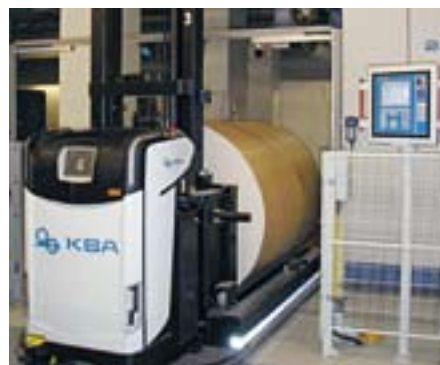
7 Automatische Beschickung der Rollenwechsler mit Gabel-AGV
