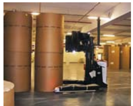
3 Rolleneinlagerung im Hauptlager mit Klammer-AGV
