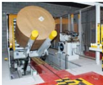
4 Durch die Kippstation wird die Rolle horizontal auf den Patras-Rollwagen abgelegt
