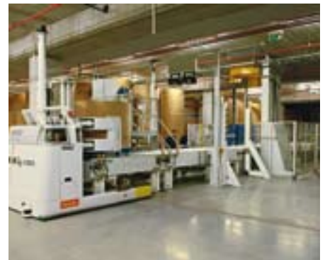
2 Rollentransport am Wareneingang mit Klammer-AGV, Rollenvereinzelung und Barcodescannen
