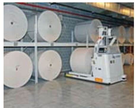
6 Rolleneinlagerung im Tageslager mit Gabel-AGV
