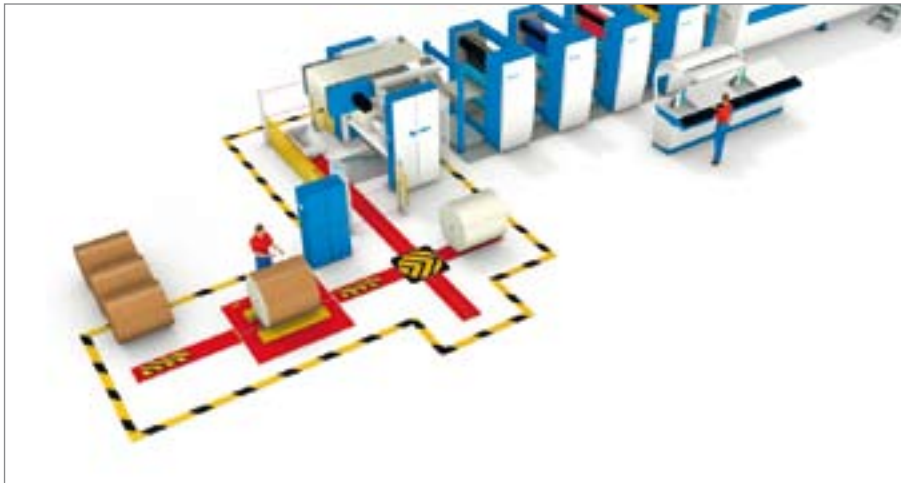
Lösung 2: KBA Patras A mit Auspackstation und Rollenpuffer an der Drehscheibe
