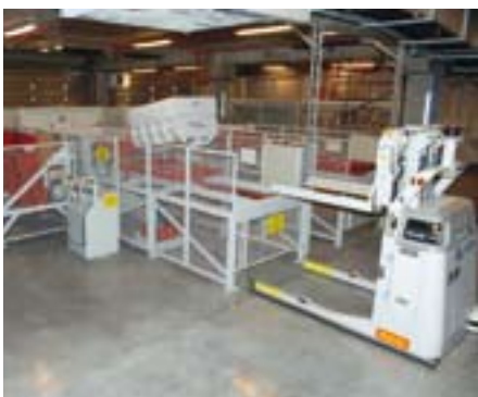
8 Entleerung des Makulatur-/Resthülsen-Behälters an der Entsorgungsstation
