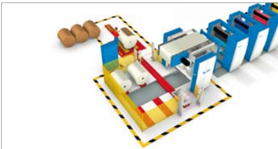
Lösung 4: KBA Patras A mit Auspackstation und Rollenlager
