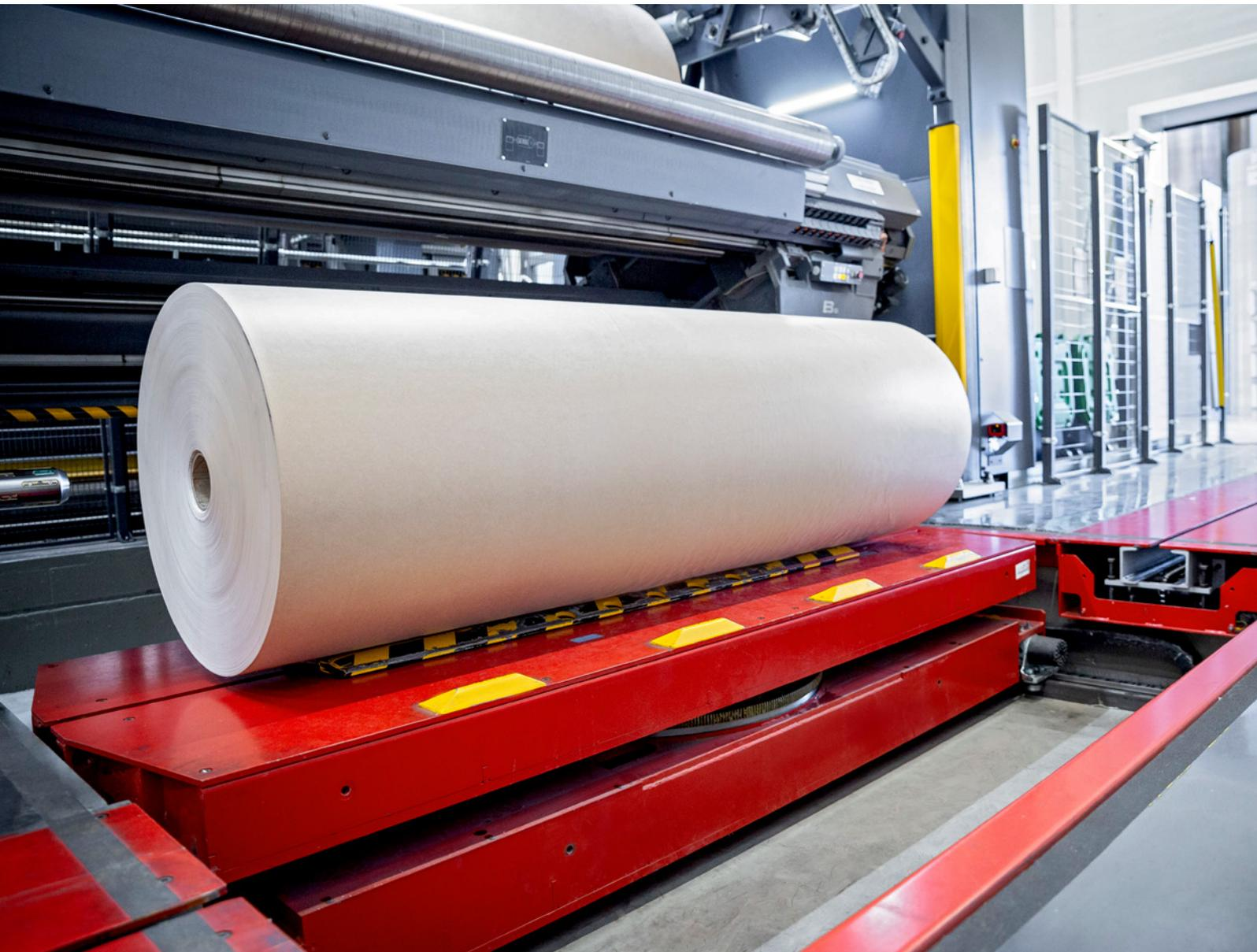
Automatische Versorgung des Abwicklers auch mit besonders breiten Substratrollen.
