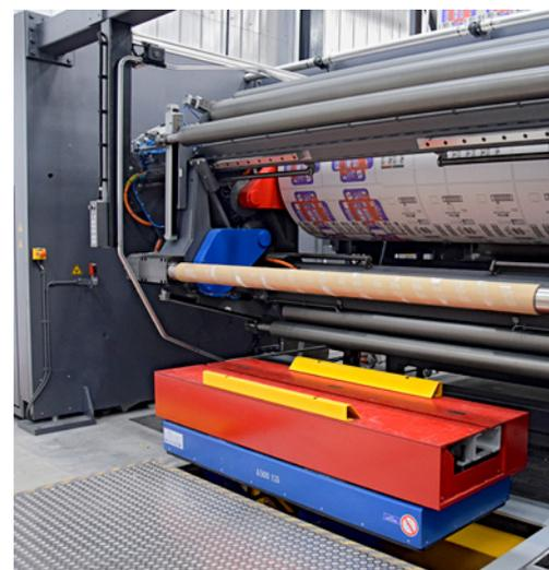
Nach dem Bedrucken wird die Substratrolle vom Aufwickler aus automatisch in das Lager transportiert.
