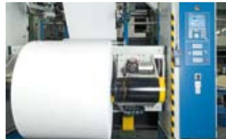
Wartungsarme AC-Antriebe in den Rollenträgerarmen für den Antrieb und die Bremsung der Papierrollen
