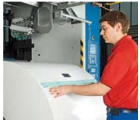
Automatischer Rollenwechsel mit hoher Klebesicherheit bei voller Maschinengeschwindigkeit
