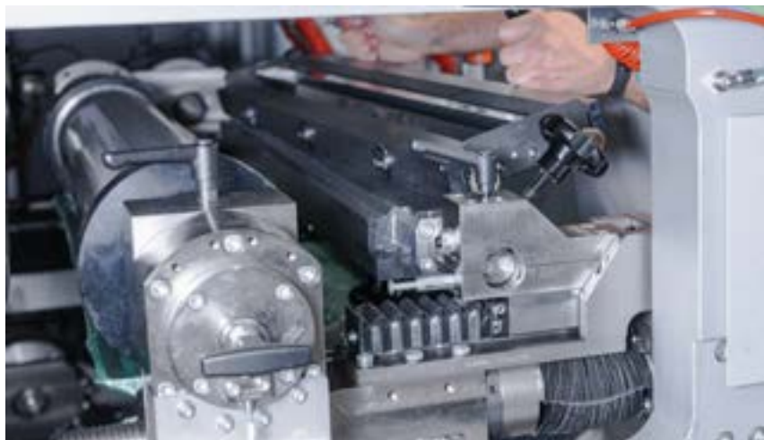
Schnellwechselsystem für Rakelkammer, Messer und Dichtungen
