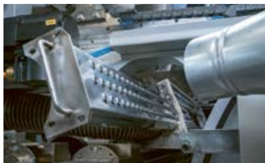
Optimierte Konfiguration ermöglicht homogene Hitzeübertragung und verbessert die Trocknungskapazität
